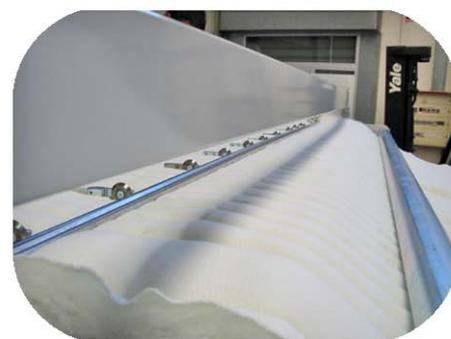
Máquina de corte de fajas con enrollador por barra central.
